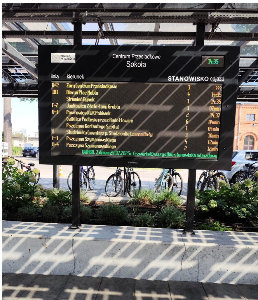
Rys.21 Przystankowa tablica rozkładu jazdy pszczyńskiej komunikacji powiatowej prezentująca w czasie rzeczywistym informacje o liniach i godzinach odjazdu autobusów
