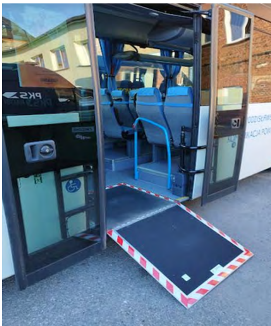
Rys. 16 Rampa do obsługi osób niepełnosprawnych w autobusie komunikacji powiatowej
